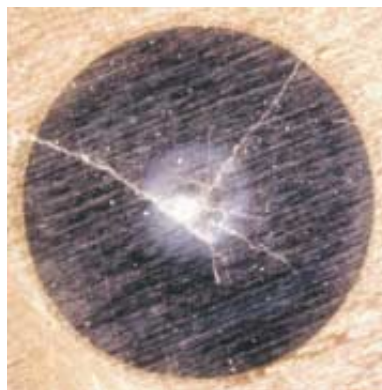
図 1.5: 熱負荷によって破壊された SLC 加速器の標的 ([6] より)
