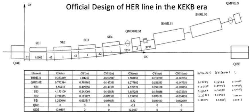
注1: GX, GY座標系の原点はQJ4Eの磁板の外端とリングビームラインの交点である。
