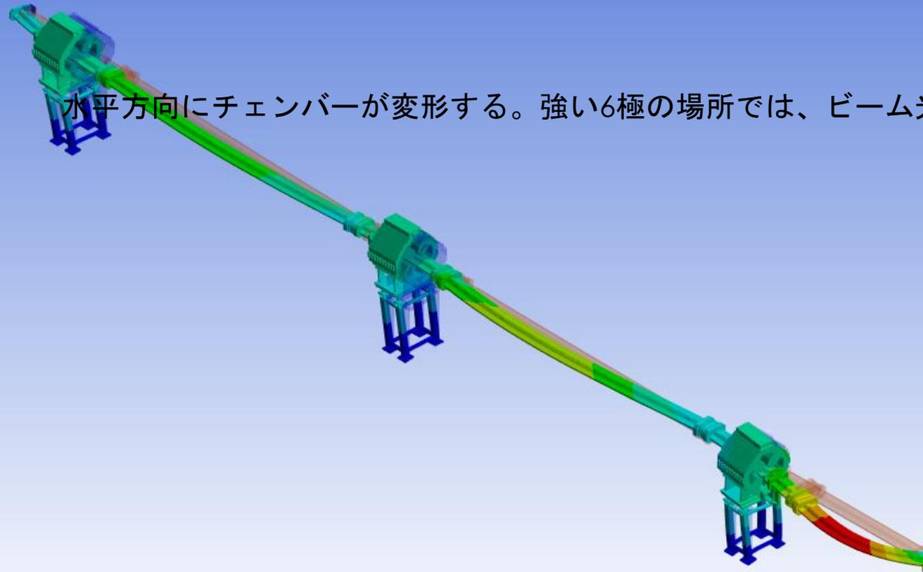
水平方向にチェンバーが変形する。強い6極の場所では、ビーム光学系 ( $\beta$ 関数) が大きく歪む。
