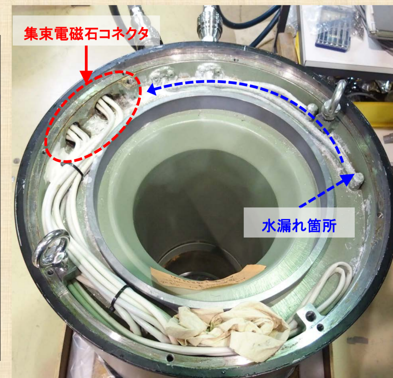
●(1)項 1台目の集束電磁石コネクタからの水漏れの様子。
