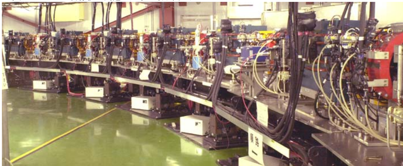
図1：低エミッタンスビームを作り出すATFダンピングリング アーク部
