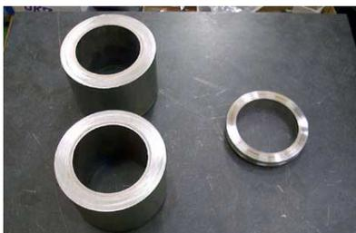
図5：Nb/(Cu)/SUSのパイプ材とフランジ
