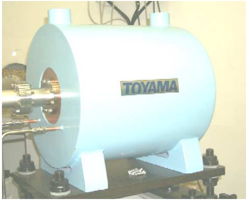
図 2 : PXR 用ビームダンプの写真
