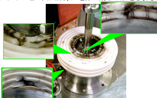
図 5：放電後の様子。上面にコロナ放電の跡が見られ、1 箇所の短絡部分を確認した（左上：短絡箇所を上から撮影、右下：下から撮影）。また、メタライズ端は大きなコロナ放電の跡のほかに、小さい放電跡も確認できる（左上）。
