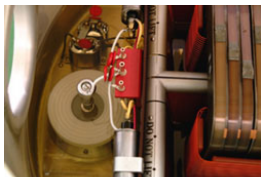
図 3：クライストロンオイルタンクにインストールした容量性分圧器 (disk 型)。
