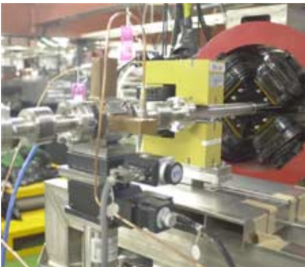
図2：X-Y ステージに設置されている空洞型ビーム位置モニター
