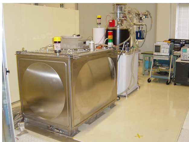
図1：密閉型変調器電源 及び クライストロン
