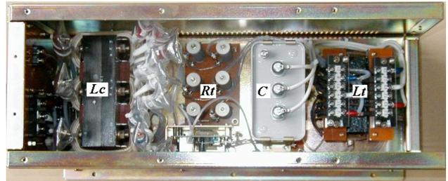
図6. 高調波フィルタの内部実装図
