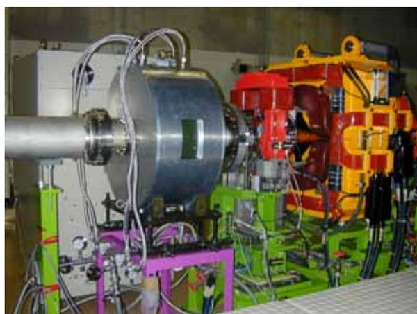
図 2 実験で使った無同調高周波加速空洞。空洞の後ろが push-pull の高周波増幅器で、ドライバーアンプ及び真空管の電源は別の部屋に設置してある。
