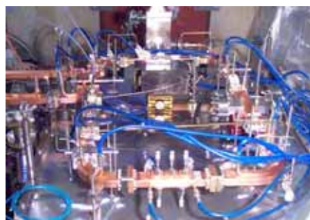
図3 : レゾナントリングの導波管系、クライストロンからの高周波出力を重畳させることで10倍以上の透過電力を得ることができる
