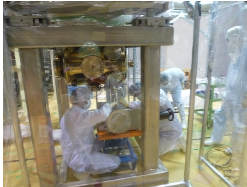
クリーンブース内で電子銃チェンバの組み立て(2012/10/23)
