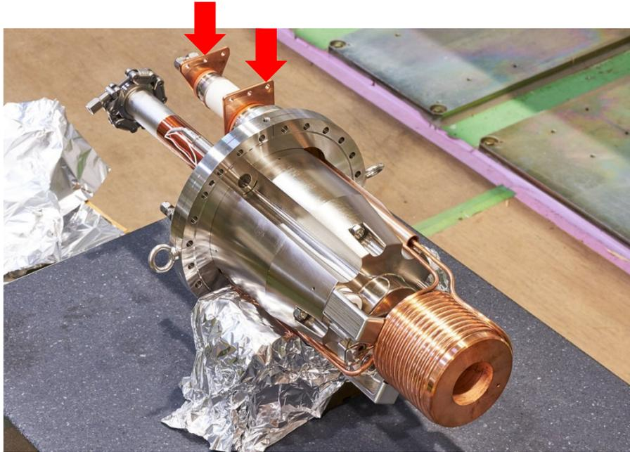
矢印部にインピーダンスアナライザ (keysight, E4990B)を接続して測定
