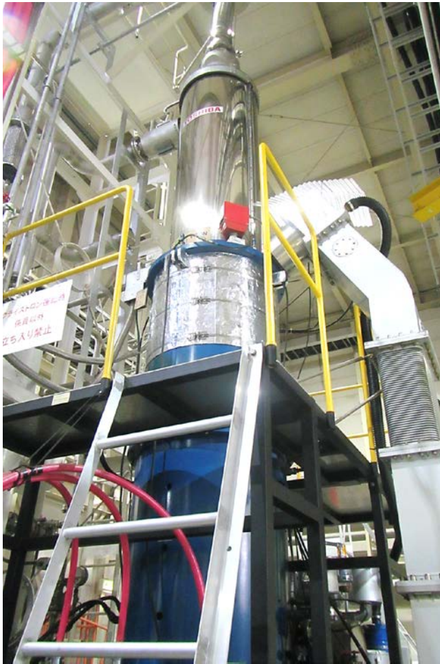
1MW CW クライストロン (509MHz)
