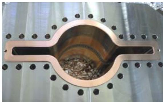
図3：アンテナチェンバーを両側に持つ円形ビームダクト用の櫛歯型RFシールド付ベローズ試作器
