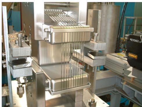
図3 極薄セプタムモデル機
