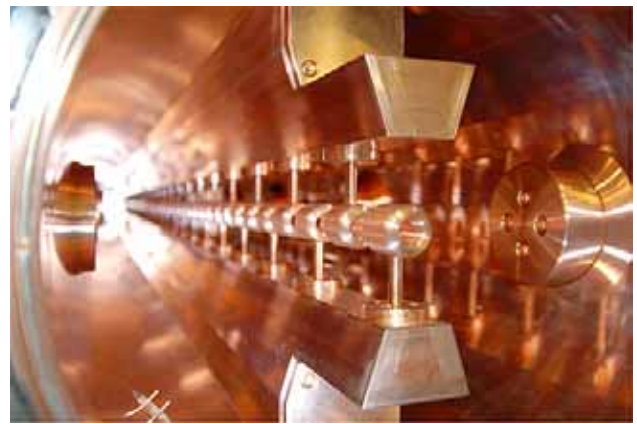
図4：APF方式IH型DTLの内部構造
