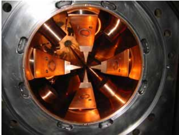
図2：RFQ線形加速器の内部構造
