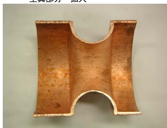
図4 ローラの転写性がいいくびれ形状、 但しコーナー部にバリが発生した パイプ厚み3.1mm、アイリス部厚み2.0 mmであり、アイリス部の厚みのばらつきは、2.0から2.3mmの範囲であった。
