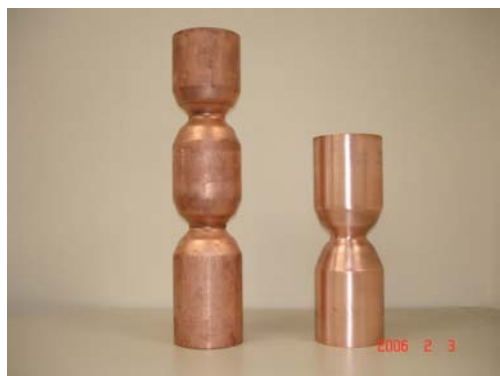
図1 パイプ材から絞り工程後の素材
