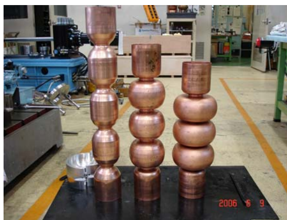
図8 3セル絞り加工後 左から絞り加工後液圧（中間、最終）成形後の空洞モデル 右端のモデルが完成状態
