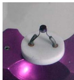
図3 Single Crystal LaB6カソード(φ1.75mm)
