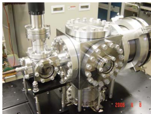
図2 低エミッタンス熱陰極DC電子銃
