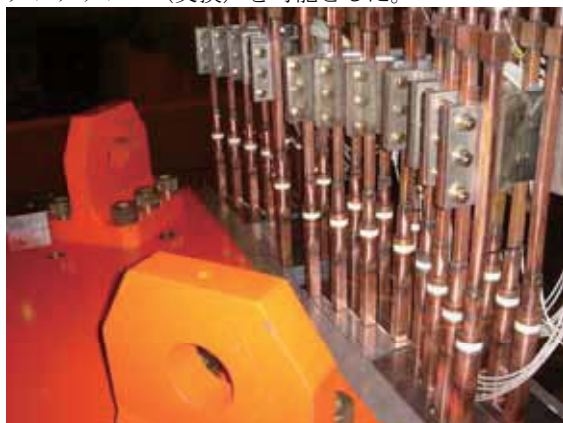
図3 端末部：電気的に直列に冷却水が16系統に分けられる導体端部 (FL-4m)
