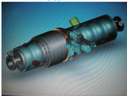
図1：開発中のLバンド高電界超伝導加速空洞 9連空洞で構成され、2 K温度下で加速周波数を1.3GHzに調整するためのSlow TunerとLorenz Force
