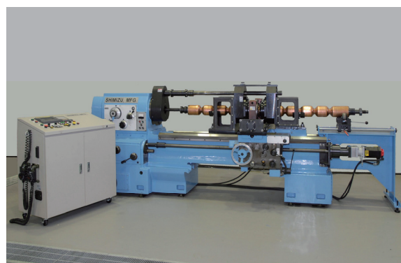
図4 9セル絞り加工が可能な ネッキング加工機の概観
