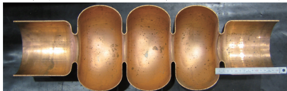
図6 液圧成形後の3セル空洞、軸方向断面形状
