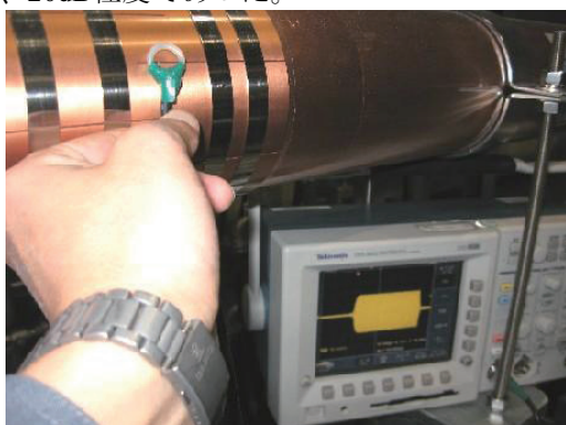
図4 同軸管(120D)接続部からの電波漏洩
