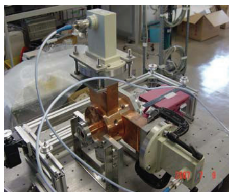
図4. コールド試験中のITC-RF gun
