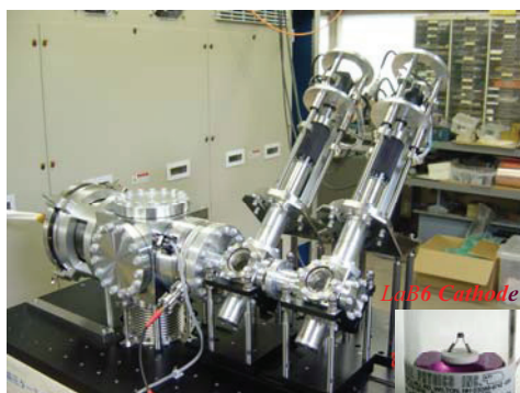
図2. 低エミッタンス電子銃とダブルスリット型エミッタンスモニター
