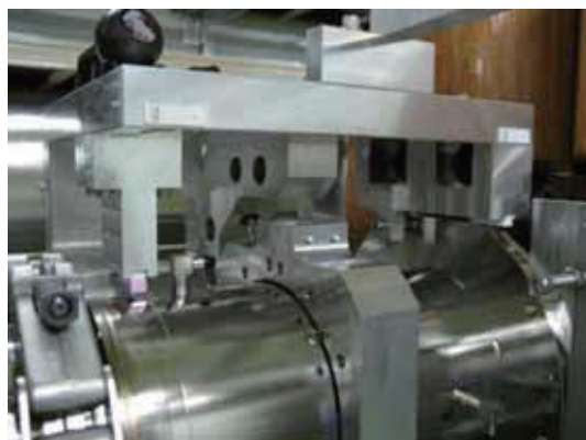
図6. BPM測量器固定機構
