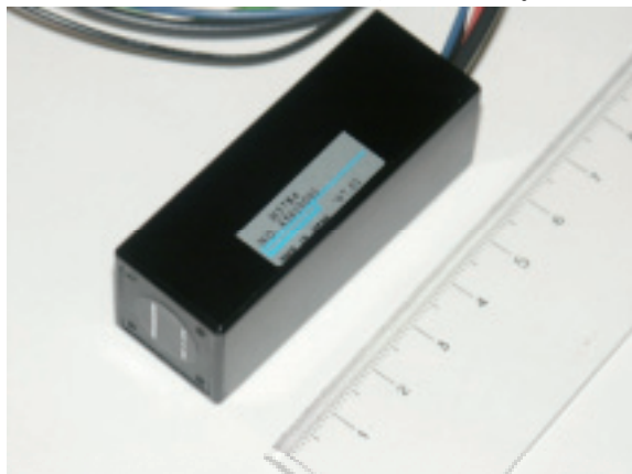
写真1 PMT (H5784; 浜松フォトニクス製) 可視域用汎用タイプ 外径寸法(W×H×D); 22.0×22.0×60.0mm 有効光面サイズ; \phi 8mm 電流電圧変換係数; 1V/ \mu A 周波数帯域; DC~20kHz 感度波長範囲; 300nm~650nm 感度調整範囲; 1:10 4 電源電圧; \pm 15V
