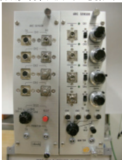
写真2 旧タイプ(左)と新タイプ(右) アークセンサの動作確認の為のLED発光スイッチとチャンネル切り替えスイッチ及びRXとTXのモニター用コネクタが設けてある。さらに新タイプにはゲイン調整のポテンショメーターと未使用チャンネルはPMTの電源電圧をOFFにするためのスイッチが
