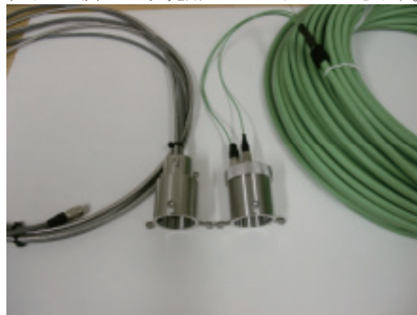
写真3 旧アダプター(左)と新アダプター(右) ビューポートはICF34、新旧ともに光ファイバーのモジュール側はFCコネクタとしている。旧タイプはヘッダーケーブルと延長用ケーブルの2種類があり組み合わせて使用するが、新タイプはアダプター側もFCコネクタで受ける構造とした。通常ファイバーの接続部分では0.3dBのロスを見込む必要があるが新タイプではその必要は無くなった。
