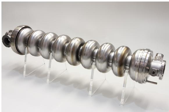
図1: Lバンド(1.3GHz)の9セル超伝導空洞
