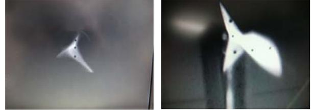
図2：左はKBrで測定した15keV、10 $\mu$ Aの陽子ビームプロファイル。右は、BaF<sub>2</sub>で測定した30keV、200 $\mu$ Aの<sup>4</sup>He<sup>2+</sup>ビームプロファイル。
