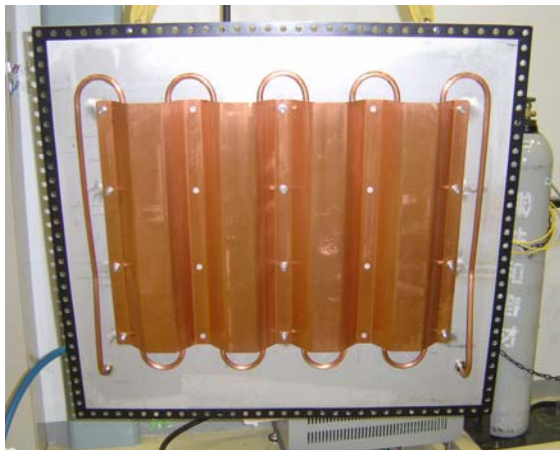
図3. 冷却板。側面開口部の蓋板に取り付けるタイプ。写真ではゴムパッキンを使用しているが、後の試験で油リークを生じたため、現在はすべてOリングのみを使用している。
