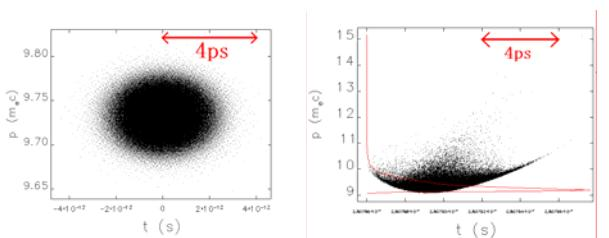
図4: バンチの進行方向位置及び運動量の分布。左図が入射バンチ、右図が減速直後のバンチ。
