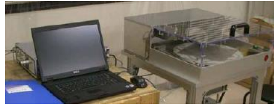
図5. 開発された Nb 素材板検査用渦流探傷スキャナー
