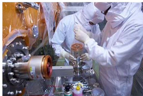
図 7 : STF-II 型カップラー室温部の取付け
