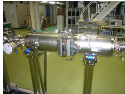
図 6 : スライドジャッキ型チューナーの取付け
