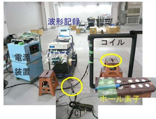
図9. 消磁電源、コイルと電流・磁場測定装置。
