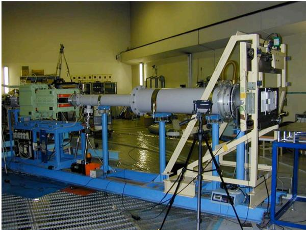
図 3: 空間的に一様分布を得られるようにワブラー電磁石が設置されている C8 コース。
