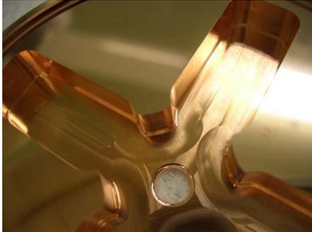
図 2 : 強減衰加速管セルの減衰孔近傍
