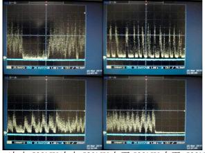
(左上;500kW,右上;520kW,左下;530kW,右下;530kW) 写真 5:様々な発光パターン(100mV/div,1sec/div) 左上の画像のみ(20mV/div,1sec/div)
