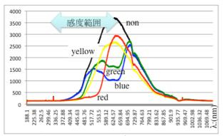
図4:簡易フィルターの透過特性
