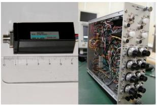
写真2: PMT とアークセンサモジュール
