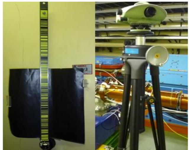
図 1 : 測量尺と測量器 (Leica 社 DNA03)
