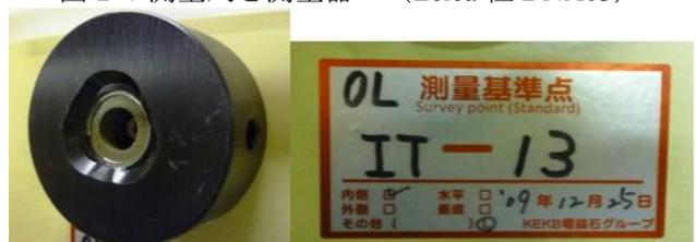
図 2 : 測量基準点と ID シール
