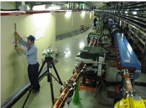
図4：DNA03を使った高さ測量の様子
