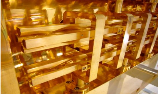
図-8 2ビーム型RFQ-IH型線形加速器の構造
