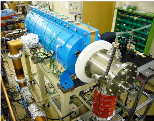
図-9 2ビーム型 RFQ-IH型線形加速器の写真
