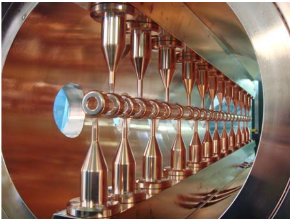
図 2: APF 方式 IH 型 DTL 内部
