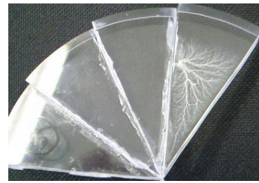
図 6: 水中に設置したアクリル板へのダメージパターン
