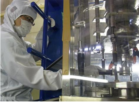
図 4: クリーンボックスのアクセス窓からバルブ操作
