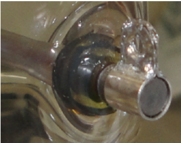
図 10 : ガラス球を貫通した導体棒と端子のカシメ
