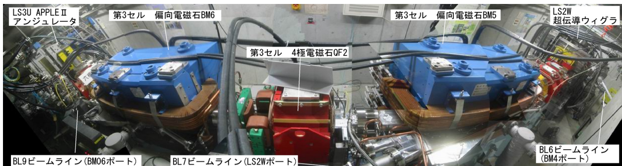
図 1 蓄積リングの現状。超伝導ウィグラービームライン BL7 基幹部より第 3 セル周辺を撮影。入射用 255MeV リニアックから構成される。現在の 射は 1 日 1 回行われ、ユーザー利用開始時の蓄積電
