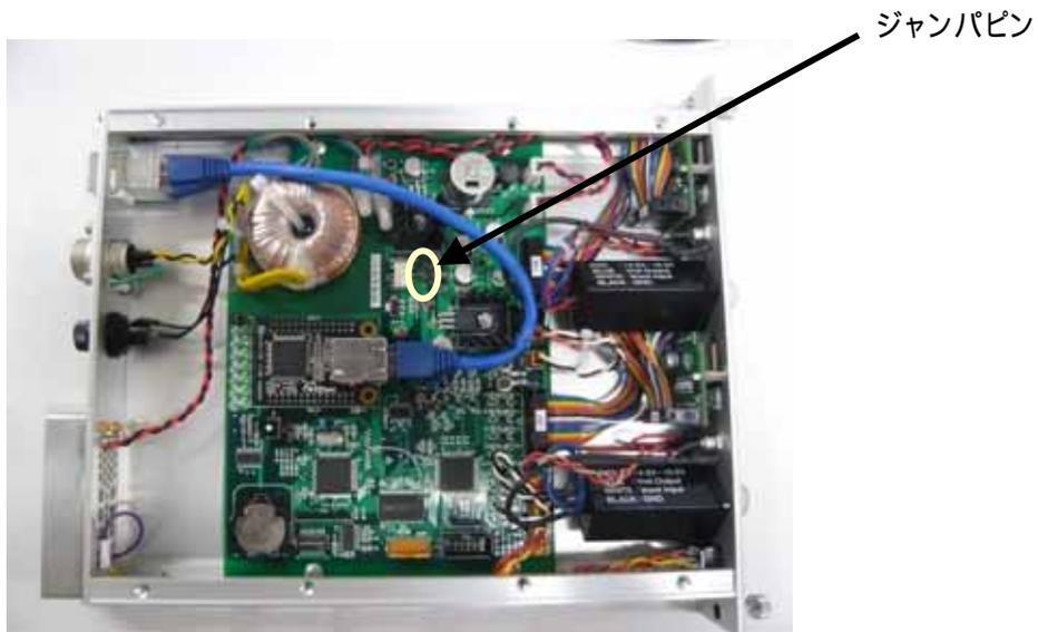
ジャンパピンの状態によってNIM+6V電源、+5V電源の対応が変わります。
