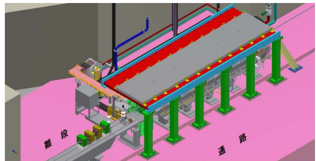
鉄遮蔽体（灰色）、柱（緑）、桁（青）、梁（赤）。
