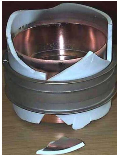
図3：故障サイラトロンのアノードギャップ部
