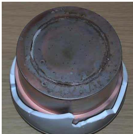
図4：故障サイラトロンのアノード部
