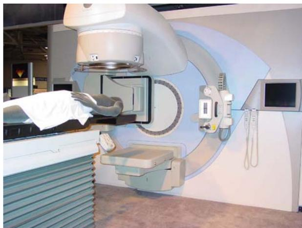
図8：ライナックにKVX線管とフラットパネルディテクタを搭載したもの
