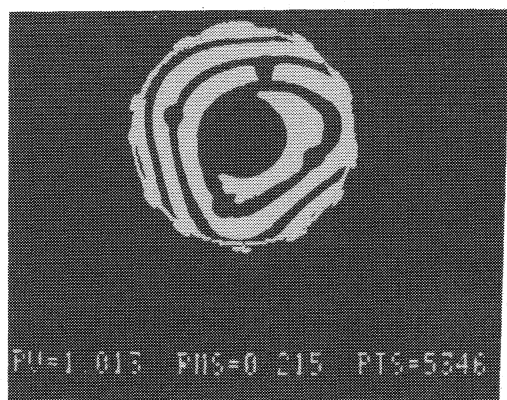
図2-2 成膜後 PV=1.031, RMS=0.215
