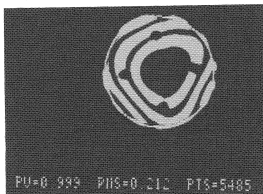
図2-1 成膜前 PV=0.999, RMS=0.212
