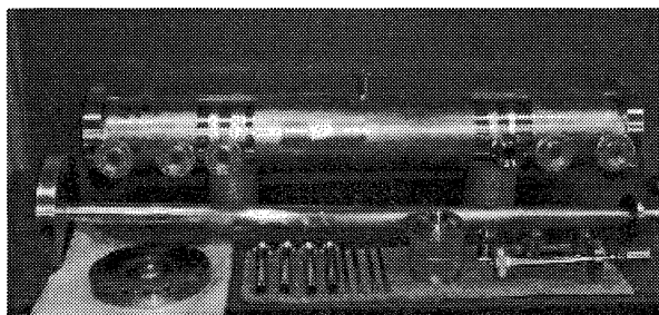
図4 同軸型モデル (CoaxPOP) とその部品
